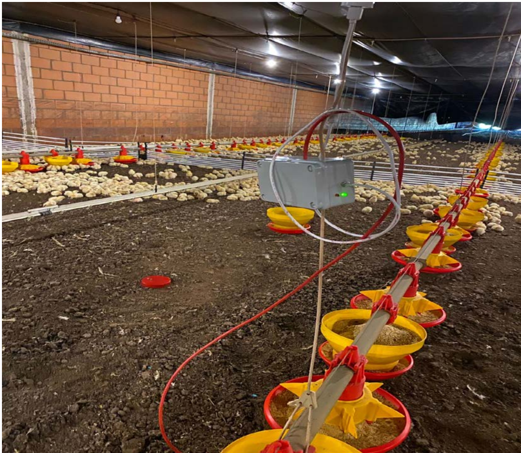
Figura 8 - Detalhe da balança montada com a célula de carga (na cor vermelho) com a presença do pintainho sendo aferido o peso vivo de forma automática
