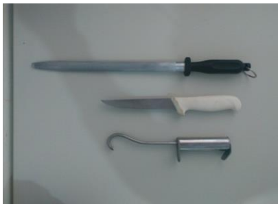
Figura 4 – Guacho inox, faca de 6 polegadas e chaira de 10 polegadas utilizados na retirada dos abscessos vacinais Fonte: Autor (2016)
