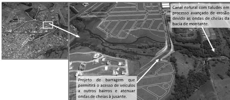
**FIGURA 7 - DETALHE DE PROJETO DE BARRAGEM NO CÓRREGO DA ALDEIA EM FERNANDÓPOLIS - SP PARA DUAS FINALIDADES: ACESSO FACILITADO PARA BAIRROS NOVOS DA CIDADE E IMPEDIR O AVANÇO DE PROCESSOS EROSIVOS NOS TALUDES DO CÓRREGO PELA ATENUAÇÃO DAS ONDAS DE CHEIAS.**
