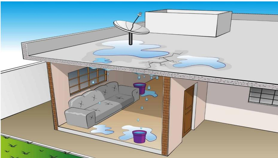
Figura 10 – desenho com demonstrações de infiltrações na laje
