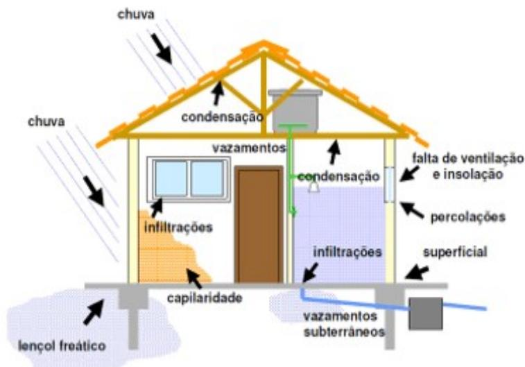
Figura 6 – esquematização de umidades/infiltrações
