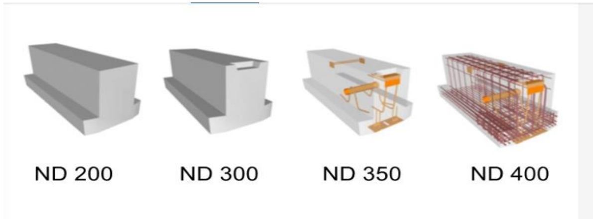
Figura 6: LOD - Progressão do ND em uma viga de concreto pré-moldado.
