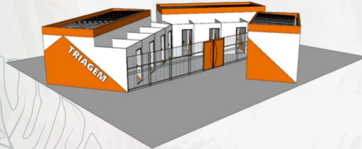
Sua estrutura é feita em alvenaria. Todo o perímetro é isolado, porém integrado com o exterior através das suas grandes esquadrias. PD=3.00m
