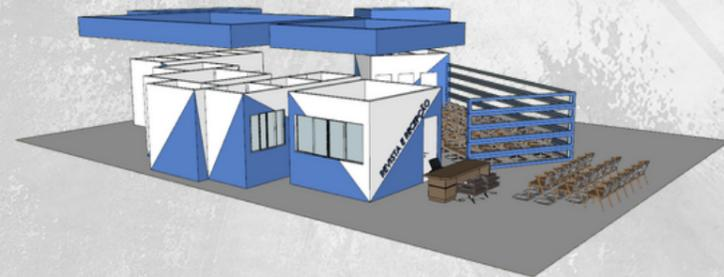
Sua cobertura é composta por telha termoacústica, calha com chapa galvanizada, e platibandas de 70cm. Inclinação das telhas de no mínimo 10%.
