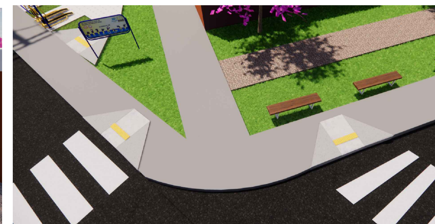
RAMPA E FAIXA DE PEDESTRE PERTO DA ÁREA DE EXERCÍCIOS PERSPECTIVA DO PROJETO
