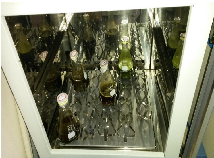
Figura 10: Metodologia utilizada para obtenção dos extratos aquosos vegetais (Agitador). Fonte: Arquivo pessoal.
