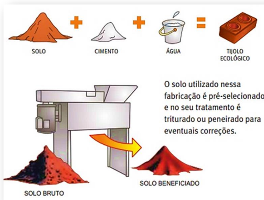
Figura 6- Processo fabricação tijolo solo-cimento Fonte: Vitulio (2013).
