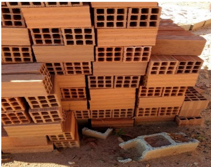
Figura 16: Tijolo utilizado na obra
