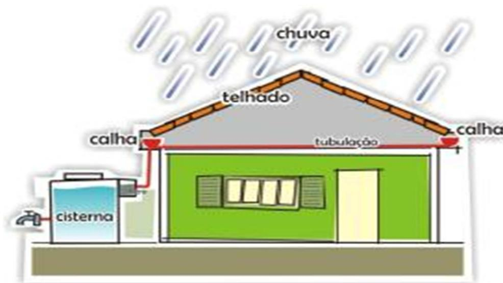
Figura 10: Esquema básico do aproveitamento das águas de chuva.
