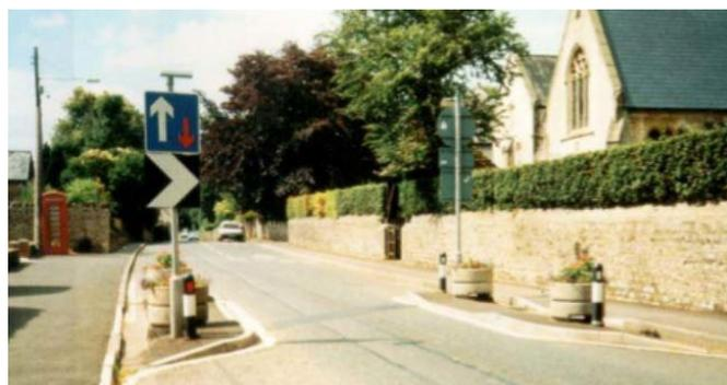
**Figura 34:** Estrangulamento da via como forma de reduzir a velocidade dos veículos automotores.
