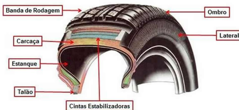
Figura 3: Componentes de um Pneu Fonte: Pneus Moretto
