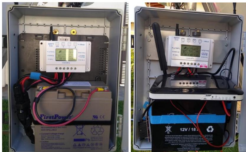
**Figura 28:** Controladores de Carga e Bateria de 18Ah 12V.
