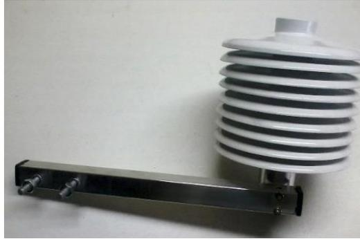
**Figura 18:** Abrigo de sensores de temperatura, umidade e pressão.
