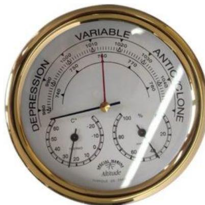
**Figura 4:** Barômetro de Aneróide.
