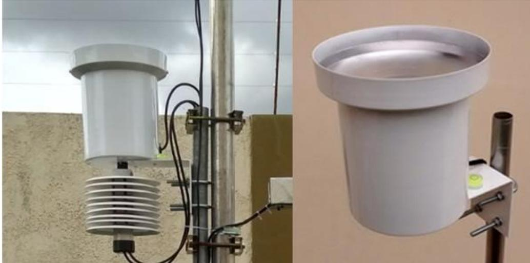
**Figura 22:** Pluviômetro automático de báscula.
