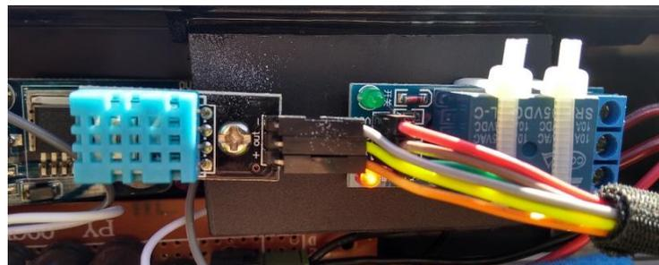
**Figura 30:** Relê e sensor de Temperatura - Sistema de Refrigeração.
