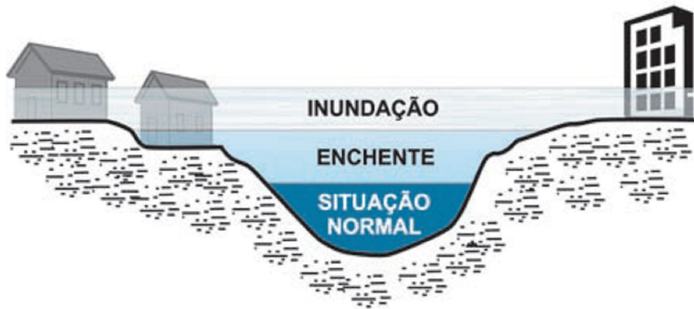
Figura 8: Perfil esquemático do processo de enchente e inundação. Fonte: Ministérios das Cidades/IPT, 2007).
