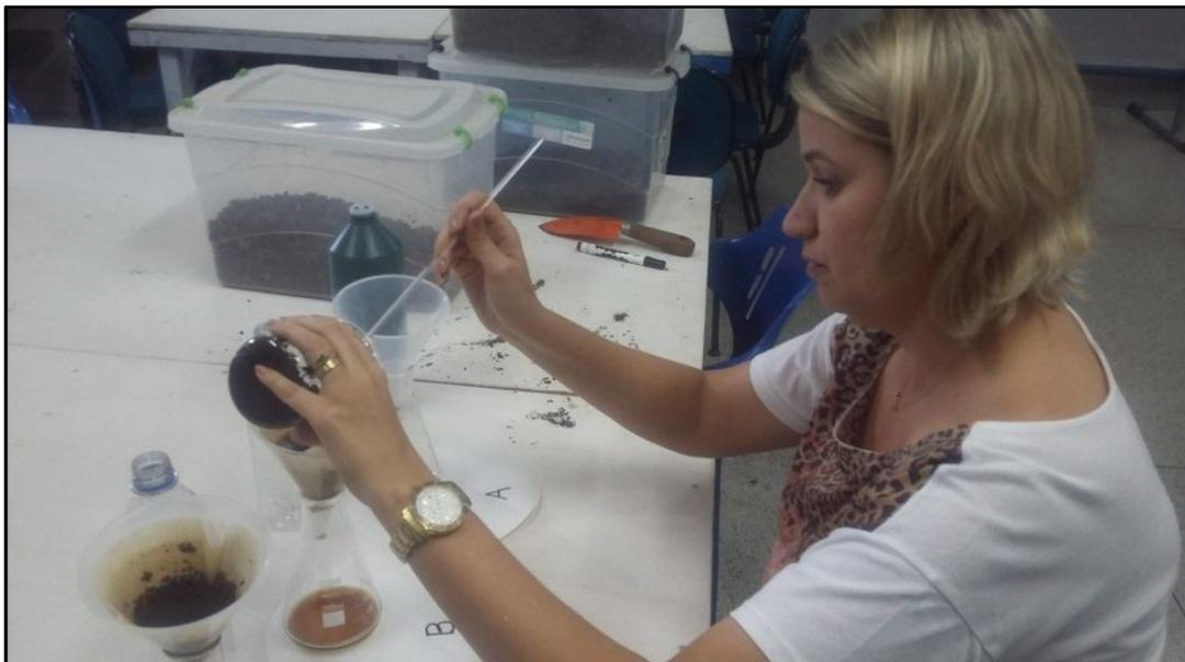
**Figura 10:** Mistura do composto com água desmineralizada.
