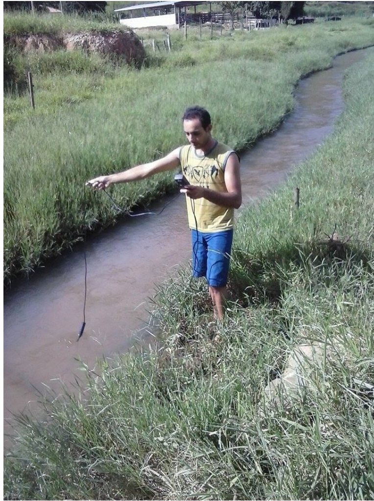
Figura 3: Aferição do OD e temperatura da água (oxímetro digital Lutron DO-5519) Fonte: acervo pessoal.
