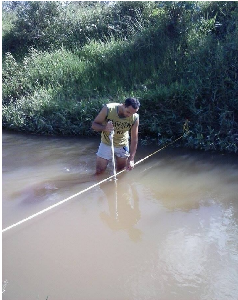
Figura 4: Processo de medição da vazão do rio. Fonte: acervo pessoal.
