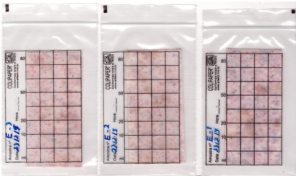
Figura 5: Foto representativa das amostras incubadas e com as Unidades Formadoras de Colônia (UFC).
