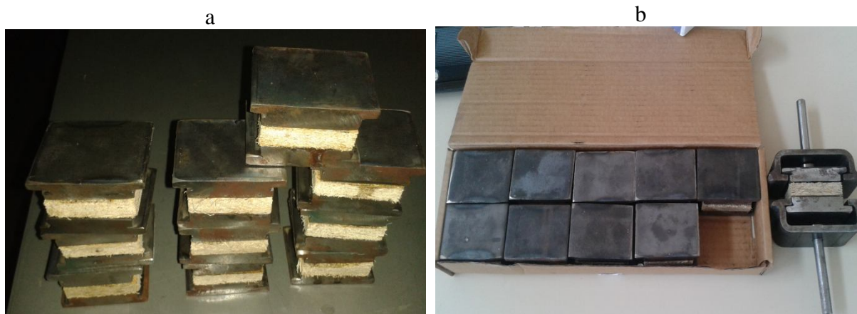
Figura 20: Detalhes dos blocos metálicos para fixação dos corpos de prova (a) e blocos metálicos para fixação dos corpos de prova com o dispositivo de tração (b)
