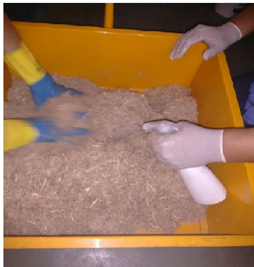
Figura 9: Detalhe do processo de mistura e homogeneização do bagaço com o adesivo e aditivo.
