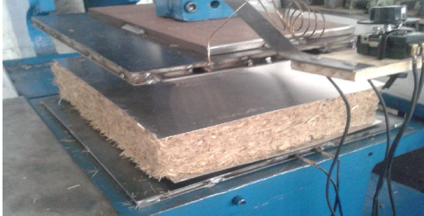
Figura 13: Detalhe do colchão pronto para a prensagem a quente, com os laminados superior e inferior revestidos de papel alumínio.
