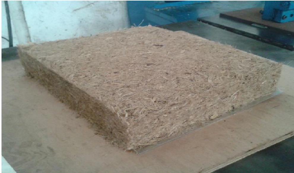
Figura 12. Colchão desformado e pronto para ser levado a prensa quente.
