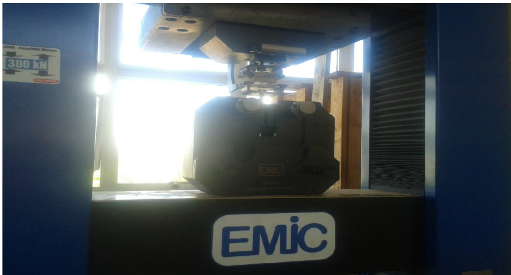
Figura 19: Máquina Universal de Ensaio EMIC DL 30000 com dispositivo para tração.
