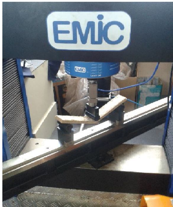
Figura 18: Detalhe do teste de flexão nos corpos de prova.
