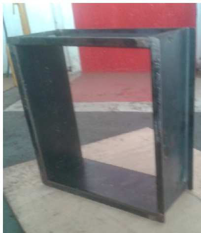
Figura 7: Detalhe do molde de aço utilizado na prensagem a quente.
