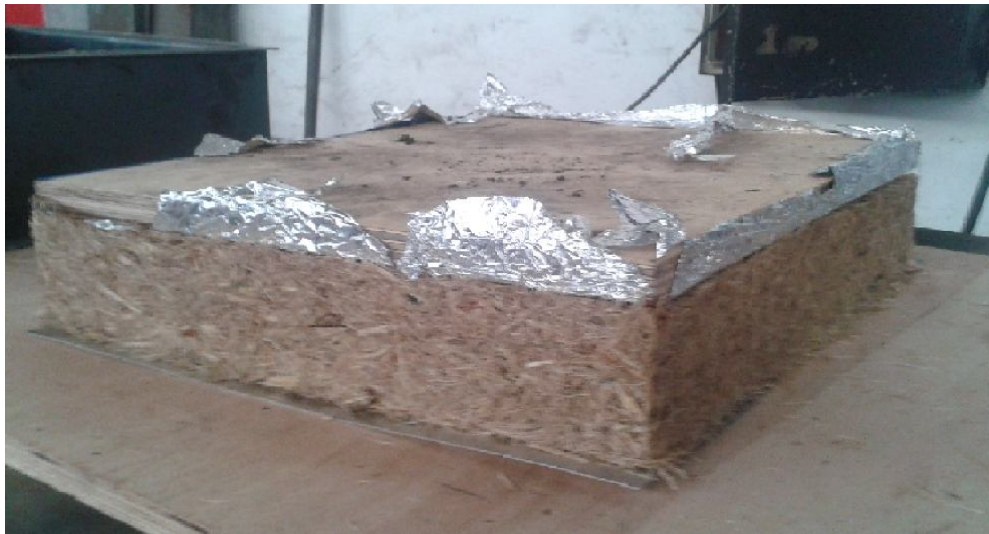
Figura 11: Colchão já formado sobre a chapa de alumínio e com a tampa embola em cima.
