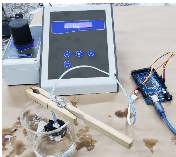
Figura 15 – Medição das amostras com o turbidímetro e sensor de turbidez. Fonte: Autoria própria (2019).
