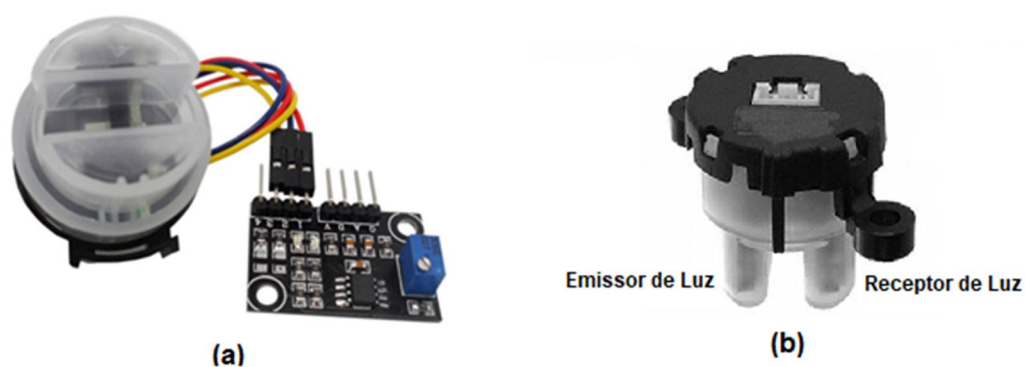
Figura 6 – Sensor de Turbidez da água e módulo eletrônico (a) vista frontal do sensor(b).
