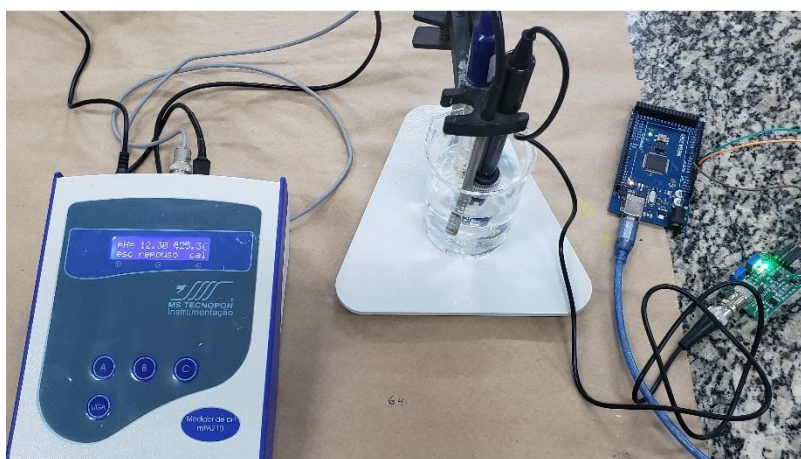
Figura 13 – Medição das amostras com o peagâmetro e sensor pH. Fonte: Autoria própria (2019).
