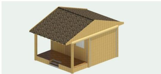
**Figura 6:** Módulo finalizado em eucalipto tratado
