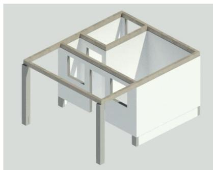
**Figura 8:** Estrutura modular em concreto armado e vedação em tijolos cerâmicos
