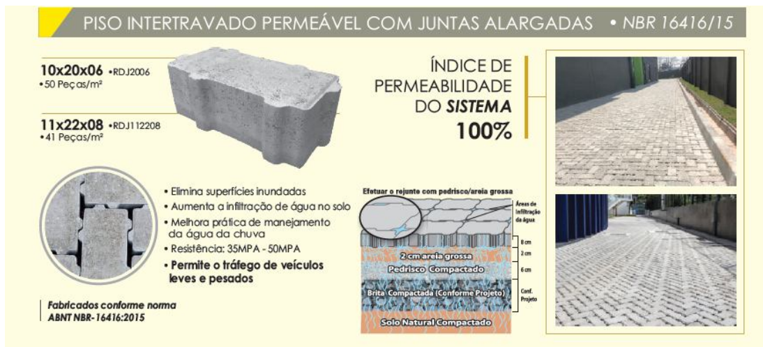
Figura 12. Revestimento de piso intertravado com juntas alargadas permeáveis Fonte: ORTEPREN (2020)
