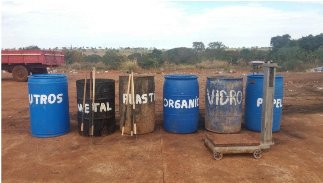
Figura 8: Dispositivos utilizados no trabalho de gravimetria dos resíduos sólidos no lixão do município de São Francisco de Sales/MG Fonte: próprio autor (2019)
