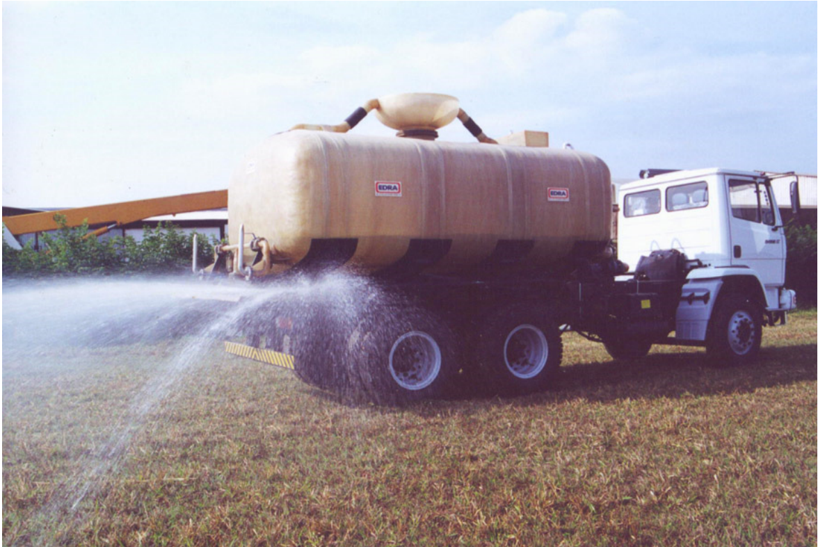
Figura 4 Caminhão utilizado na aplicação direta no solo por gravidade chuveiro. Fonte: Portal, 2014a.
