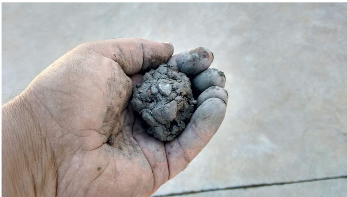
Figura 4: Consistência do concreto permeável após processo mistura
