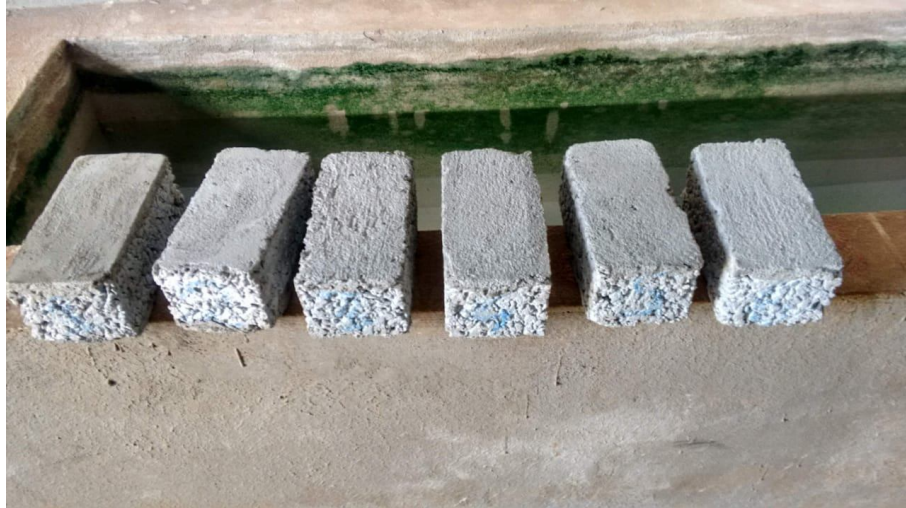
Figura 9: Corpos de prova capeados com argamassa no presente estudo Fonte: próprio autor (2020)
