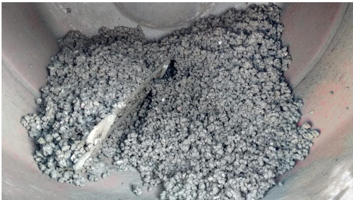
Figura 5: Verificação visual do aspecto metálico do concreto Fonte: próprio autor (2020)
