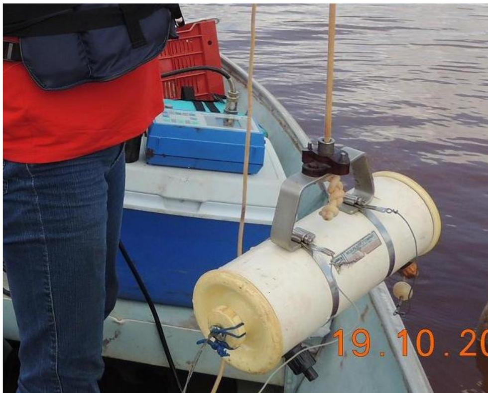
**Figura 8** Garrafa de Von Dorn utilizada para coleta das amostragens de água.
