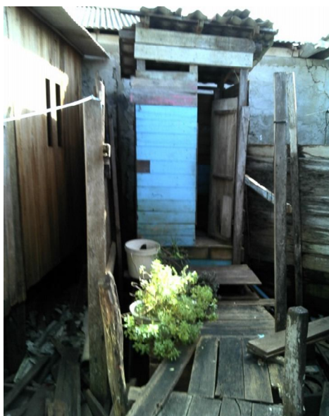
Figura 7. Fossa rudimentar utilizada nas residências para a disposição do esgoto no município de Afuá-PA.
