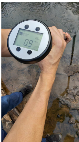
Figura 30 – Leitura realizada pelo molinete hidrométrico. Fonte: Autoria Própria (2020)
