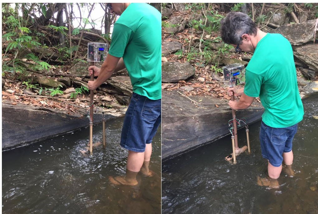
Figura 38 – CF-SPEED 20 em funcionamento no córrego. Fonte: Autoria Própria (2020)
