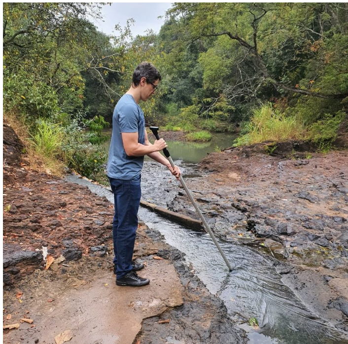
Figura 2 – medição de velocidade de escoamento por molinete hidrométrico. Fonte: Autoria Própria (2020)
