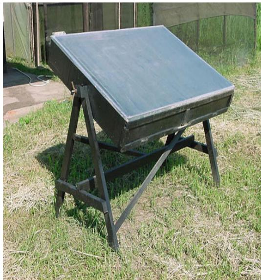
Fig 4: Coletor solar.
