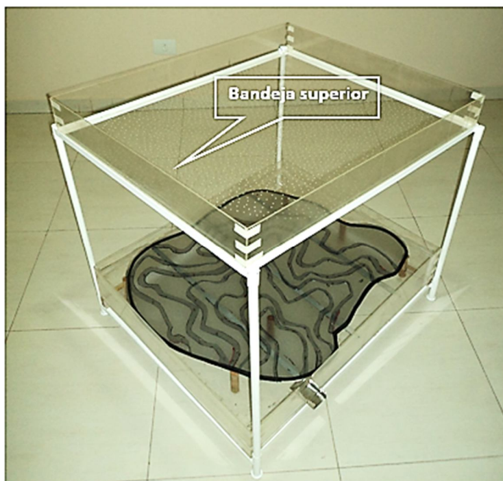
Figura 28. Detalhe da bandeja superior sobre o suporte da bandeja superior.
