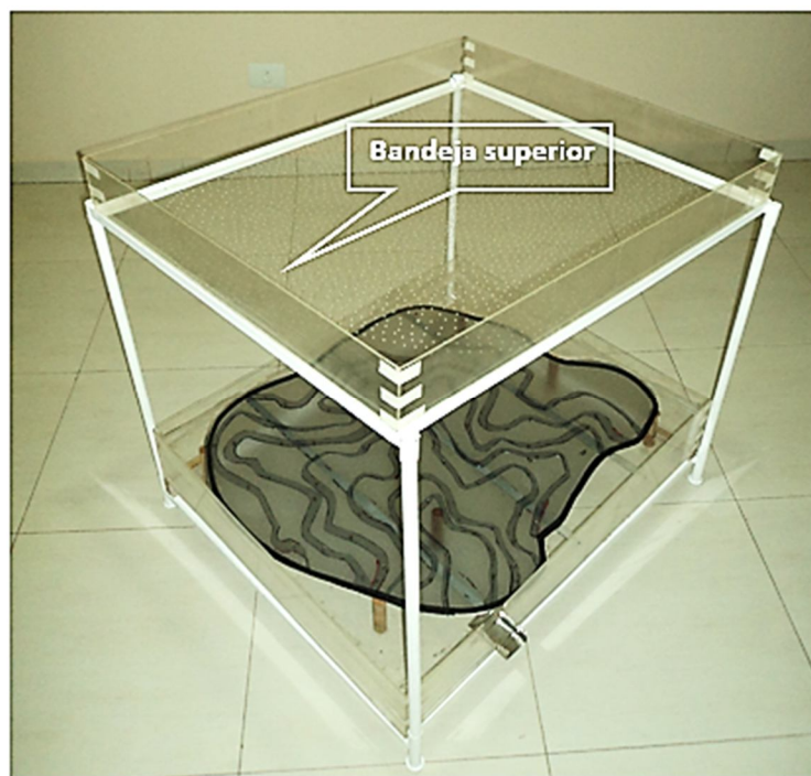
Figura 7. Detalhe da bandeja superior sobre o suporte da bandeja superior (pronta para uso)
