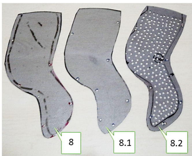
Figura 19. Detalhe das peças 8, 8.1 e 8.2 do corpo da bacia com três diferentes variações de densidades de furos.
