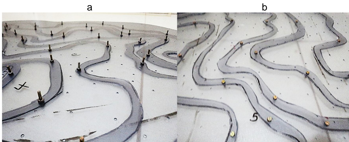
Figura 18. Detalhe dos parafusos com porcas utilizados na junção das peças do corpo da bacia.
