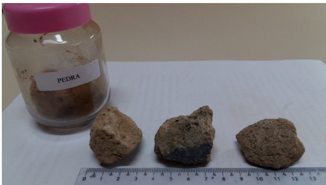
Figura 50: Subproduto do RSCC: pedras obtidas pela separação dos materiais (observar as medidas na régua).
