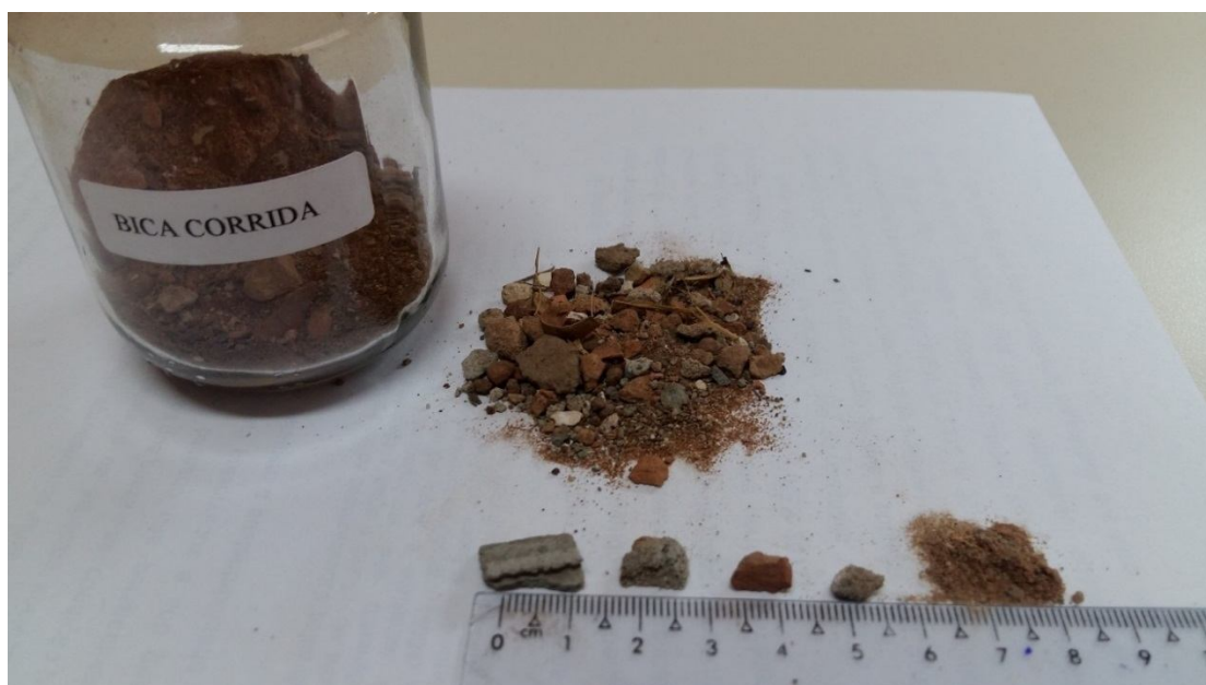
Figura 46: Bica corrida de RSCC misturado, ainda sem separação.
