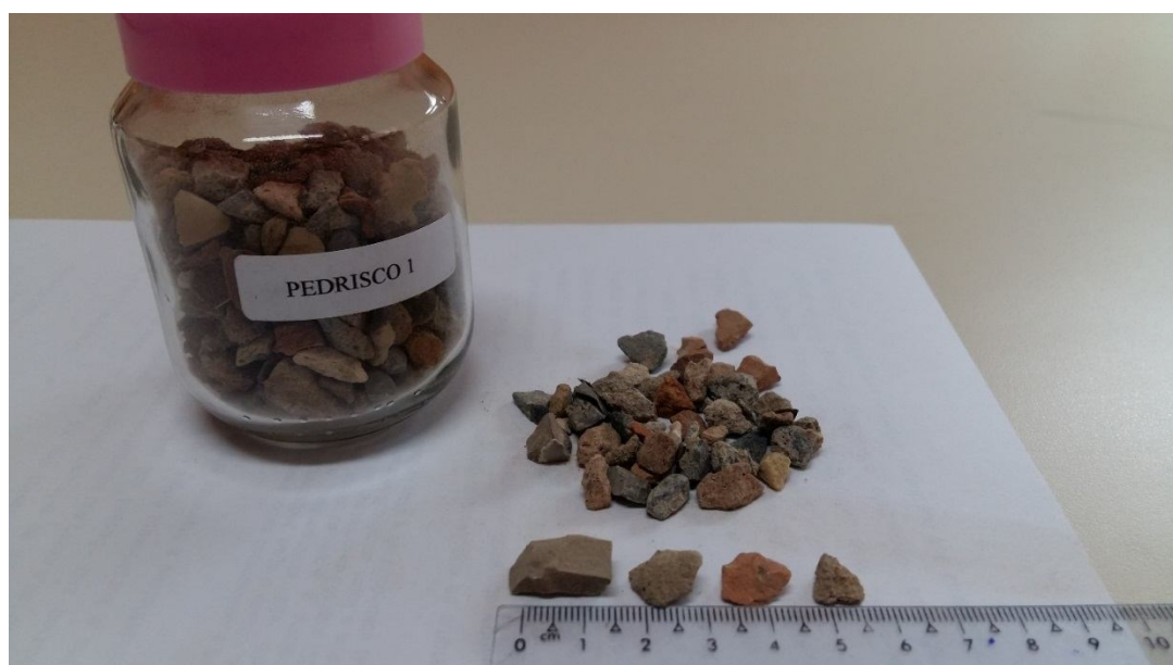
Figura 51: Subproduto do RSCC: pedriscos de tamanhos diversos (observar as medidas na régua).
