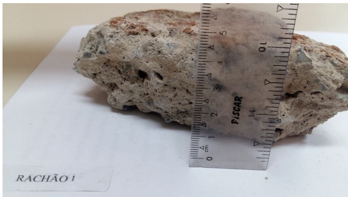
Figura 48: Subproduto da construção civil: rachão oblongo/ovalado, com largura aproximada de 6 cm. Fonte: O autor, 2016.
