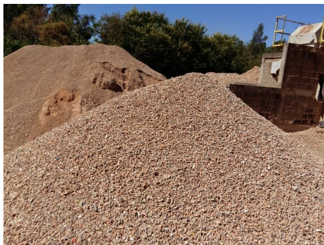
Figura 33: Pedrisco – material reciclado pela usina Mejan Ambiental. Fonte: O autor, 2016.
