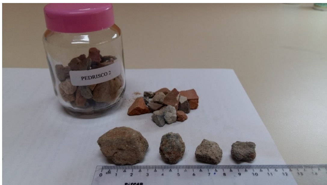
Figura 52: Subproduto do RSCC: pedriscos de tamanhos diversos (observar as medidas na régua). Fonte: O autor, 2016.
