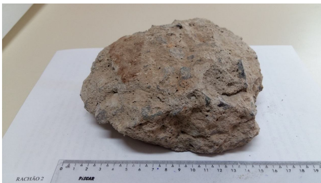
Figura 49: Subproduto da construção civil: rachão arredondado com cerca de 16 cm. Fonte: O autor, 2016.
