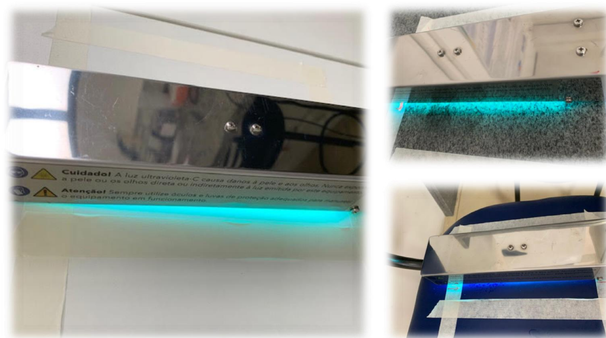
FIGURA 3: IRRADIAÇÃO DE DIFERENTES SUPERFÍCIES COM MOVIMENTOS DE VARREDURA CONFORME RECOMENDADO PELO FABRICANTE
