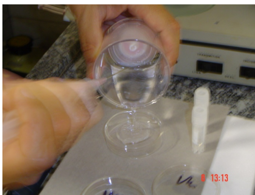
Figura 5: Lavagem do filtro e colocação do fluido obtido em uma placa previamente riscada para o rastreamento de CCOs.
