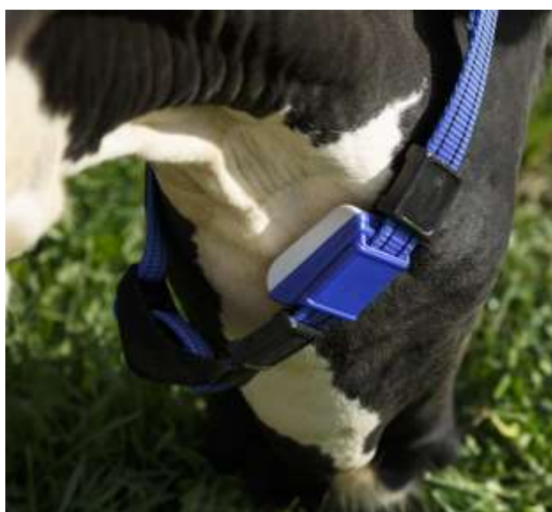
Figura 7- Medidor de atividade ALPRO®, fixado no pescoço das fêmeas leiteiras. Fonte: https://www.delaval.com/globalassets/inriver-resources/document/brochure/delaval-activity-meter-system.pdf/ ALPRO®, DeLaval International AB, Tumba, Suécia
