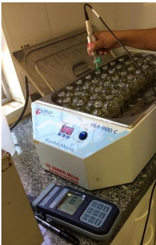
**Figura 1.** Leitura da pressão interna nos frascos em incubação em banho-maria com auxílio de manômetro digital. Fonte: Arquivo pessoal
