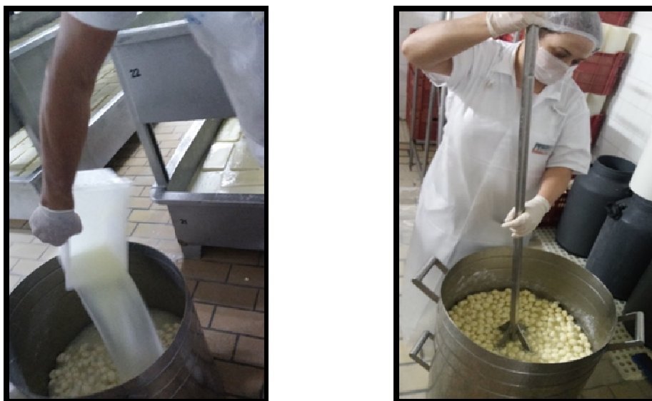
Figura 13: Adição de salmoura aos nozinhos (à esquerda) e homogeneização (à direita).
