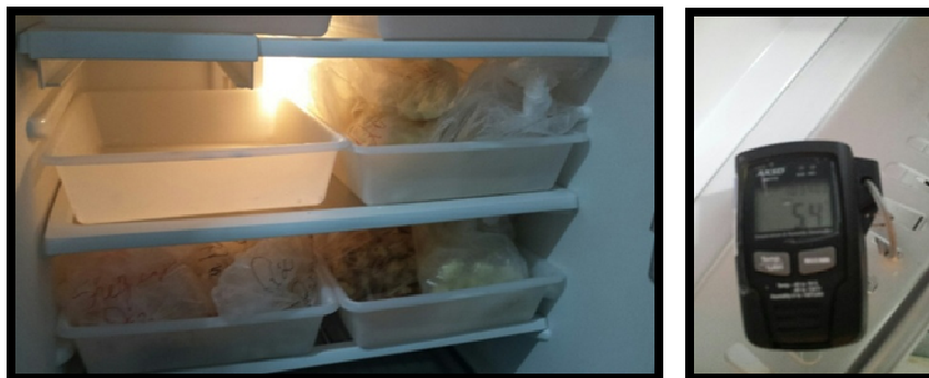
Figura 29: Amostras dos queijos tipo muçarela nozinho acondicionados em geladeira (à esquerda). Temperatura monitorada por termômetro digital (à direita).
