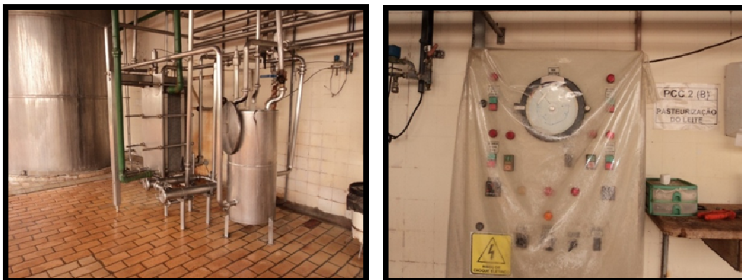
Figura 5: À esquerda, aparelho de Pasteurização e, à direita, o termo registrador do mesmo aparelho.
