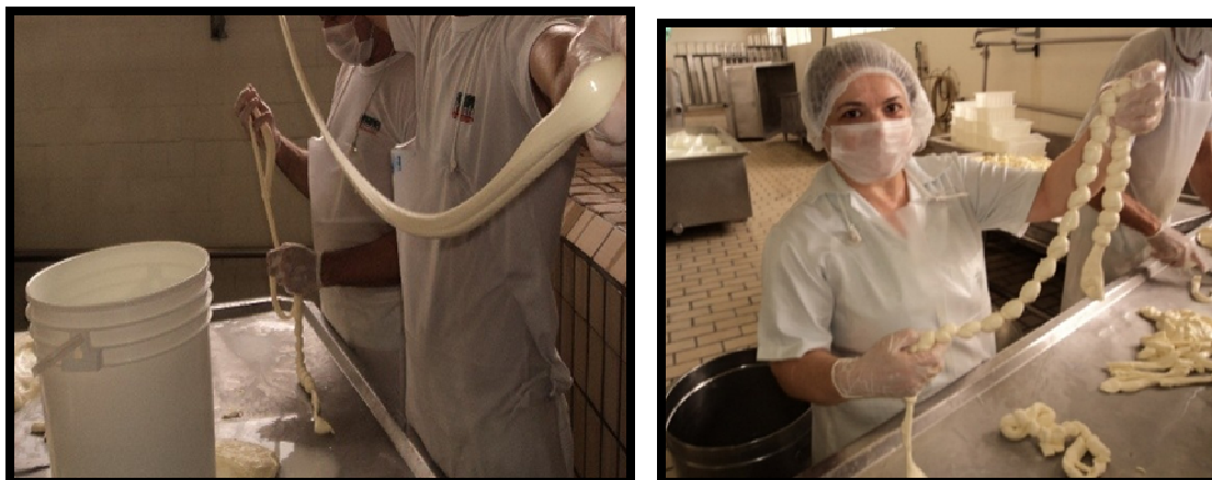
Figura 10: À esquerda, afinação da massa e, à direita, moldagem dos nozinhos.
