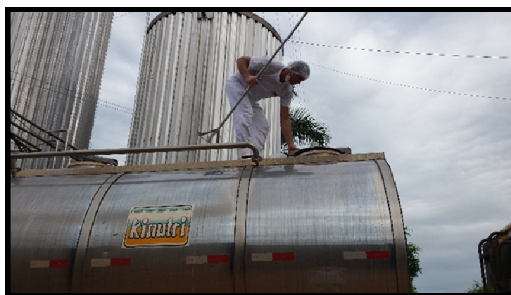
Figura 2: Coleta de amostra de leite armazenado em tanque isotérmico de caminhão transportador de leite para o laticínio.
