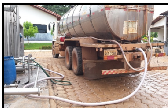
Figura 4: Descarga do leite contido no tanque do caminhão para o silo.
