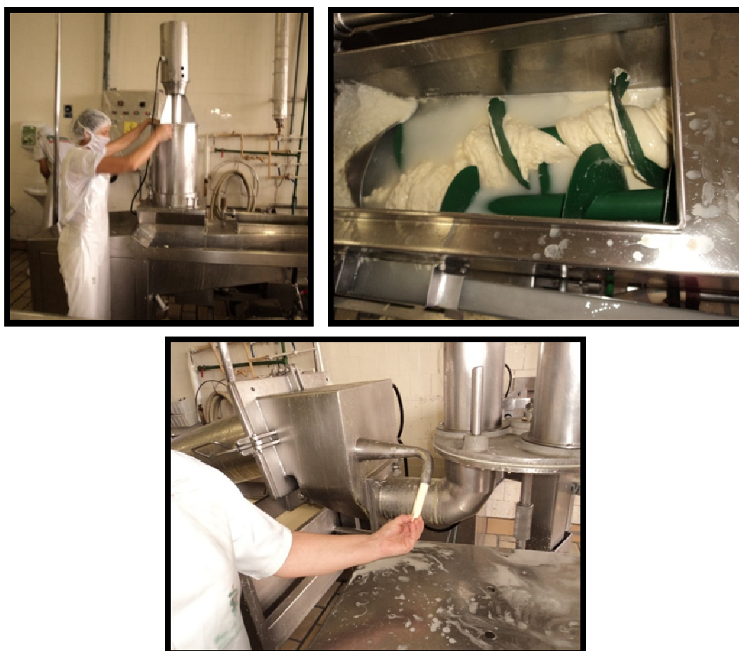
Figura 9: Acima, à esquerda trituração da massa com posterior banho em água aquecida; acima e à direita, massa sendo filada e direcionada pela rosca até o local de moldagem (abaixo).
