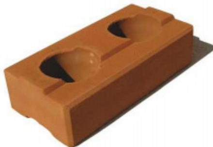
**Figura 4:** Tijolos de solo-cimento
