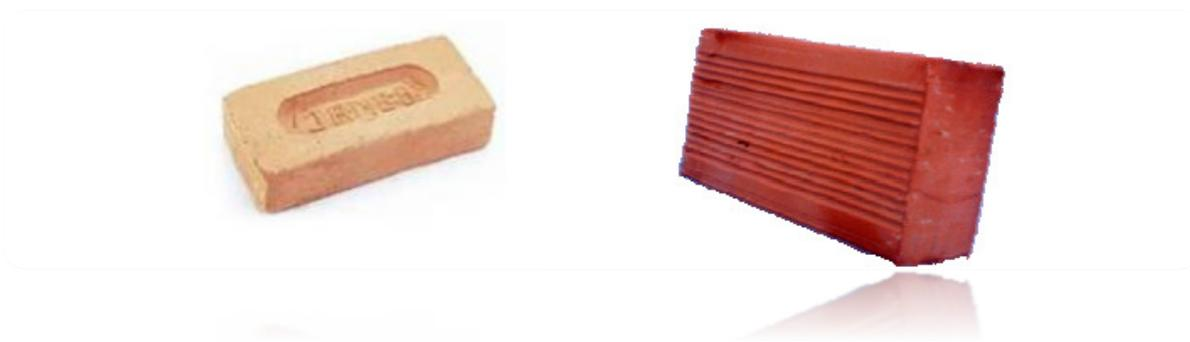
**Figura 2:** Tijolos maciços moldados à mão e por extrusora.
