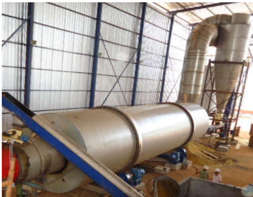
**Figura 11:** Secador de grãos secos de destilaria (DDG), diminui a Matéria Seca de 30% para 12%-14%.
