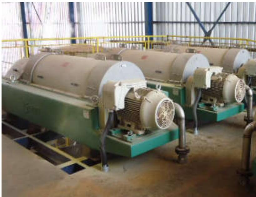
**Figura 10:** Separadoras centrifugas horizontais (centrifuga a vinhaça).
