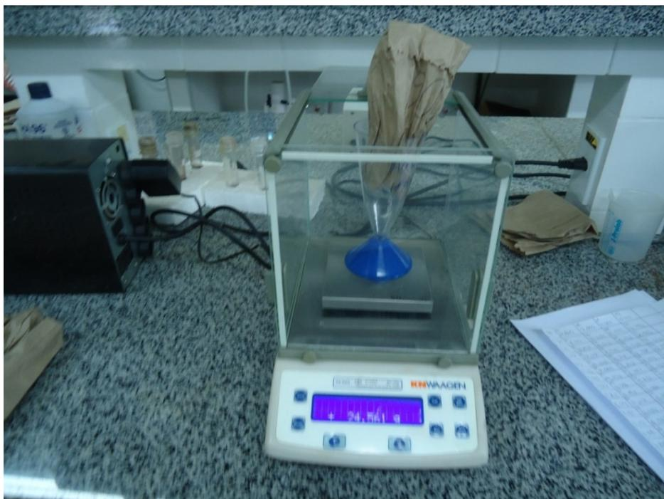
**Figura 13:** Pesagem da massa verde em balança analítica.
