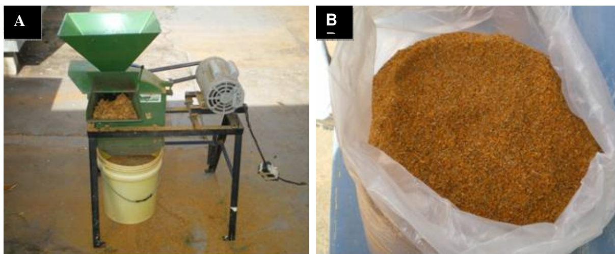
Figura 02: Moagem do resíduo em moinho tipo Willey (Modelo Thomas) providos de peneiras de 1 mm (A); Amostra do CPIT triturada, para análise (B).
