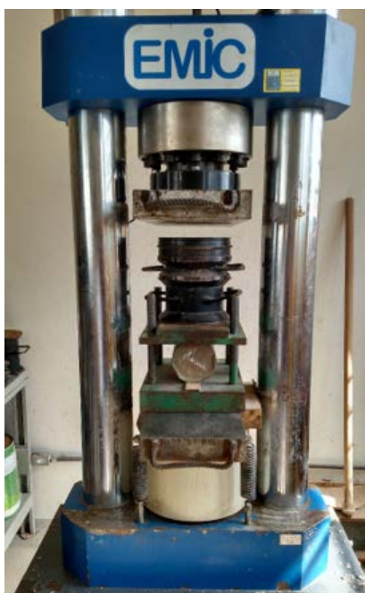
Figura 22 – Máquina Emic DL60000 célula Trd 29 sendo utilizado o método de ensaio NBR 7222 – Determinação da resistência à tração por Compressão Diametral-DL100T.
