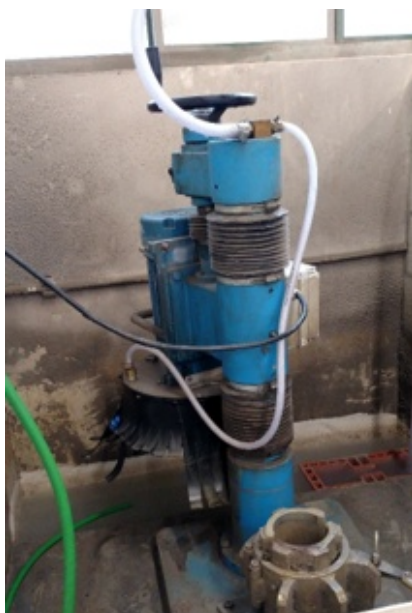
Figura 19 – Máquina Retificadora de corpo de prova.
