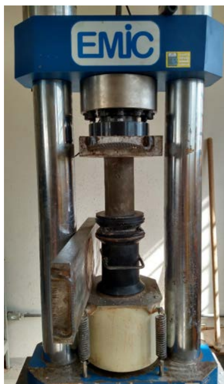
Figura 21 – Máquina Emic DL60000 célula Trd 29 sendo utilizado o método de ensaio Compressão Axial CP 10 x 20 – PC200.
