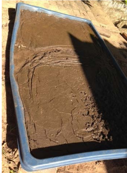
Figura 9 – Amostra de lodo coletada e exposta ao sol.
