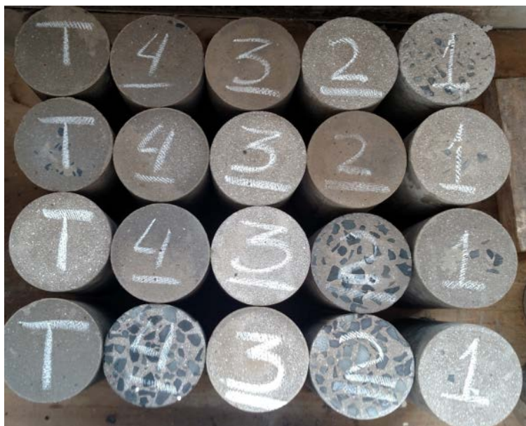
Figura 20 – Corpos de prova faceados para a compressão axial.
