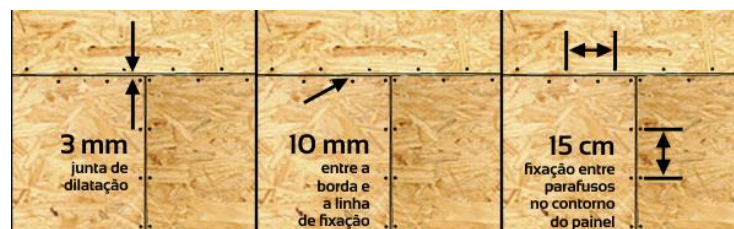
Figura 8: Fixação das chapas de OSB Fonte: atosarquitetura.com.br
