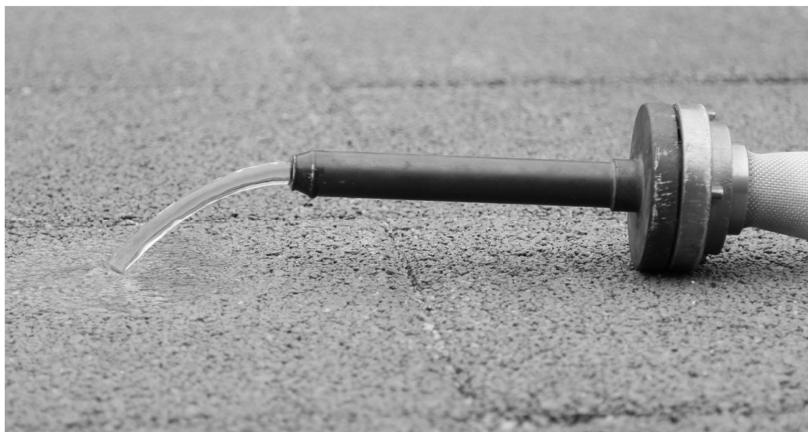
Figura 32: Teste de permeabilidade. Fonte: ABCP (2017)
