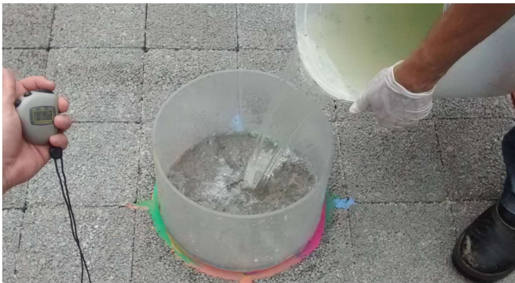
Figura 31: Teste para medir o coeficiente de permeabilidade do pavimento permeável. Fonte: ABCP (2017)
