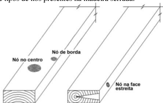
Figura 1: Ilustração de tipos de nós presentes na madeira serrada.
