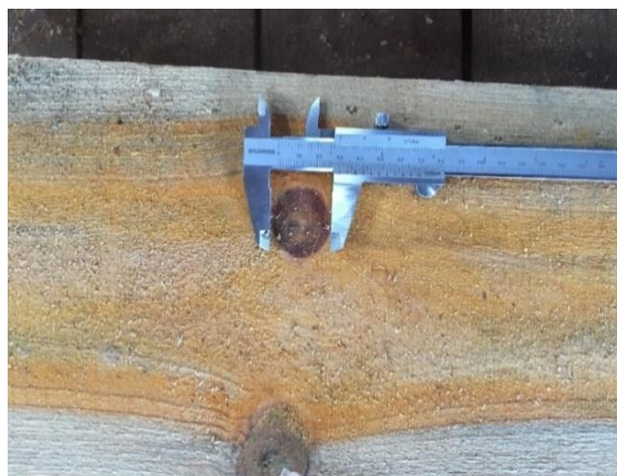
Figura 21: Medição de nó em tábua de Pinus sp.
