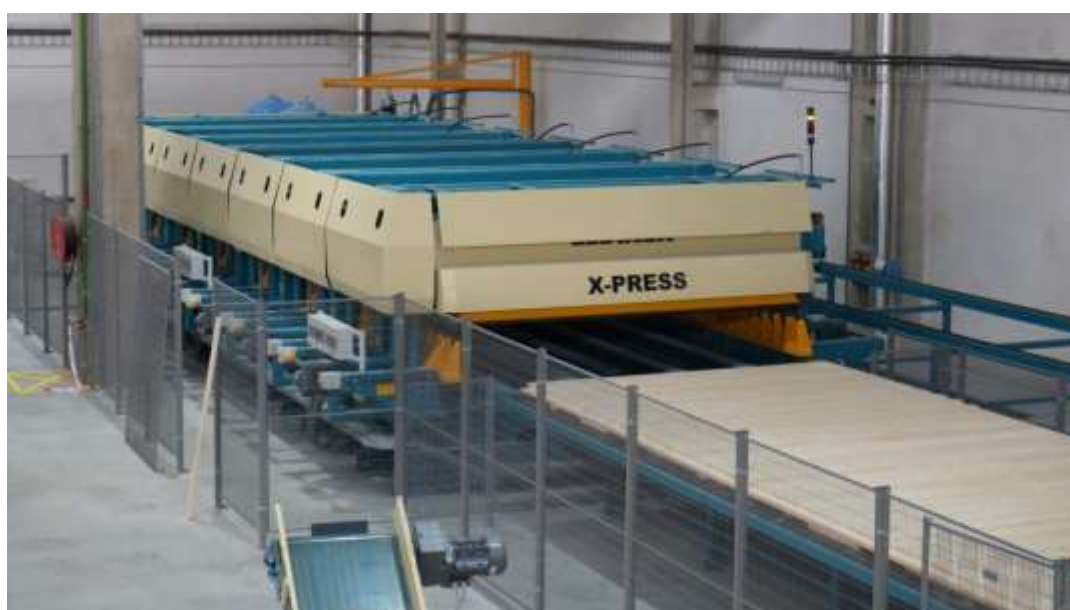
Figura 9 - Processo de prensagem dos painéis de MLCC. Fonte: Ledinek (2017b).
