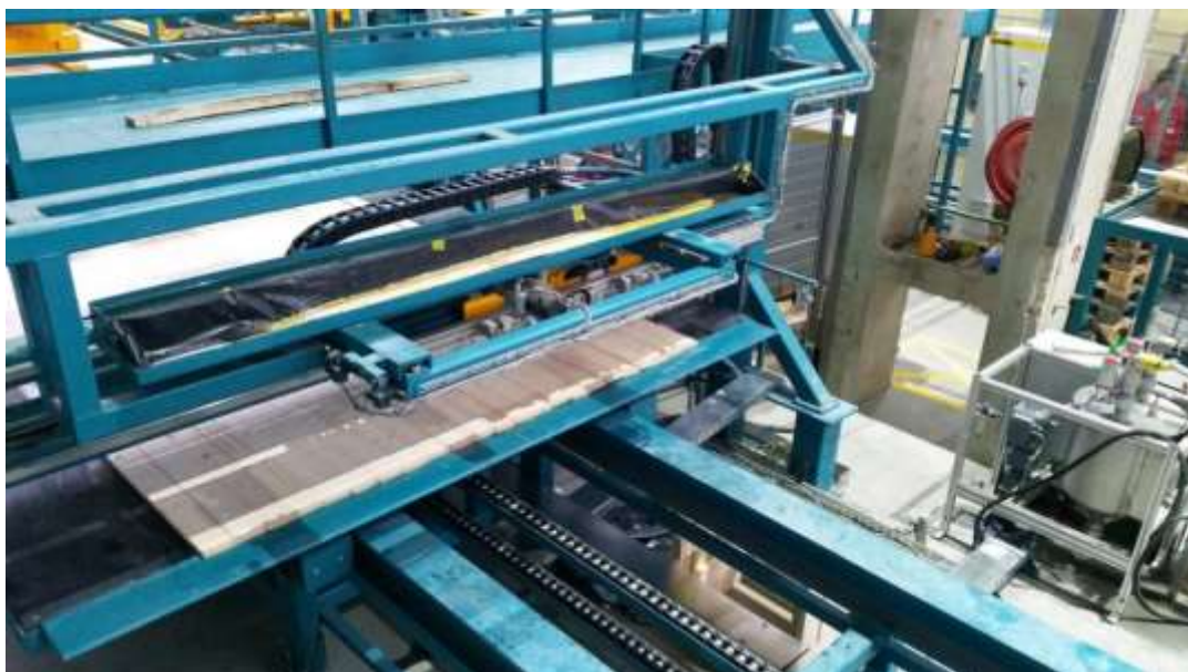
Figura 8 - Processo de colagem das lamelas dos painéis de MLCC. Fonte: Ledinek (2017a).
