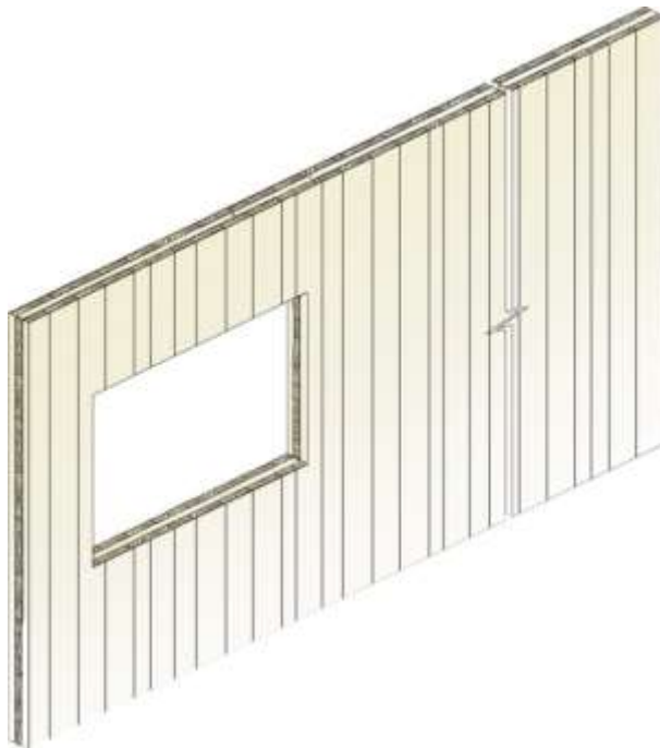
Figura 5 - Orientação externa das lamelas de MLCC para paredes. Fonte: Douglas e Karacabeyli (2013).
