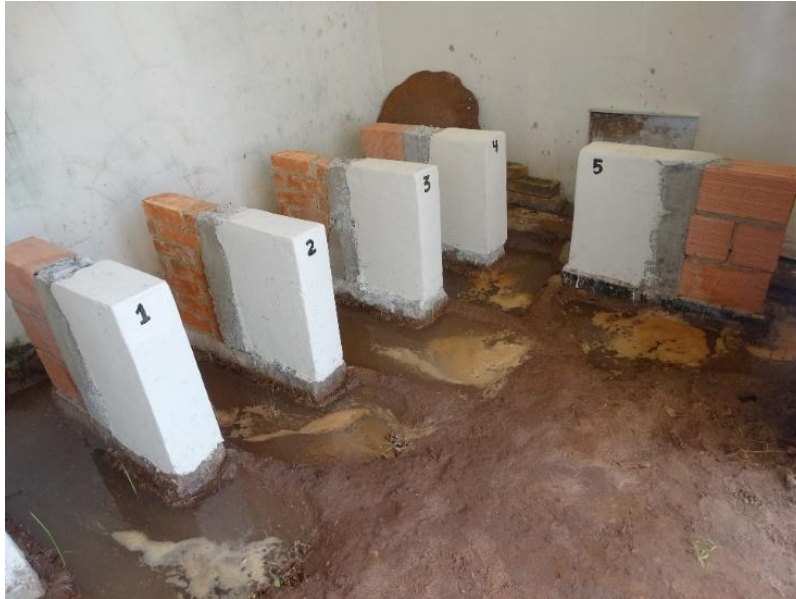
Figura 49 - Protótipos de parede finalizados desenvolvidos para a condução do experimento. (1 – baldrame sem impermeabilização, 3 fiadas de tijolo de barro de 9 furos e reboco sem impermeabilização em uma das metades da parede; 2 – baldrame sem impermeabilização, 7 fiadas de tijolo de barro maciço e reboco sem impermeabilização em uma das metades da parede; 3 – baldrame com utilização de Vedacit e Vedatop, 7 fiadas de tijolo de barro maciço e reboco sem impermeabilização em uma das metades da parede; 4 – baldrame com utilização de Vedacit e Vedatop, 3 fiadas de tijolo de barro de 9 furos e reboco sem impermeabilização em uma das metades da parede; 5 – baldrame com utilização de Vedacit e Neutrol, 3 fiadas de tijolo de barro de 9 furos e reboco sem impermeabilização em uma das metades da parede).
