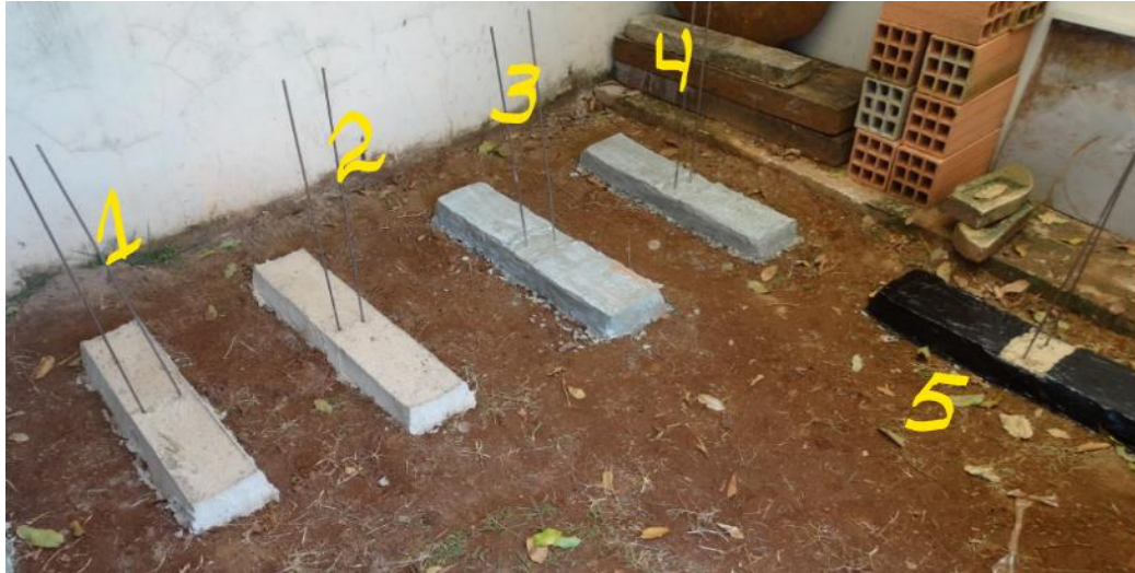
Figura 43 – Cinco vigas baldrame prontas que servirão de base para o estudo. (1 e 2: não receberam produtos impermeabilizantes; 3 e 4: receberam uma camada de argamassa impermeabilizante Vedacit e três demãos cruzadas de argamassa polimérica Vedatop; 5: recebeu uma camada de argamassa impermeabilizante Vedacit e duas demãos de tinta asfáltica Neutrol)
