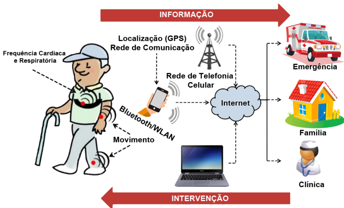
Figura 8 – Ilustração de um sistema de monitoramento remoto de integridade baseado em sensores vestíveis
