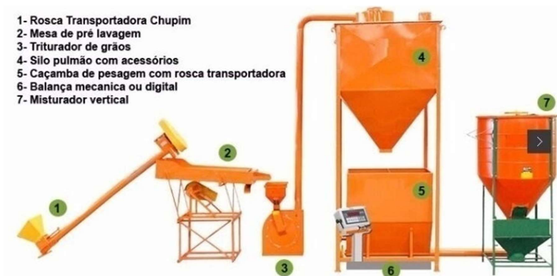
Figura 3 - Componentes da fábrica de ração. Fonte: MGM Máquinas Agrícolas e Industriais
