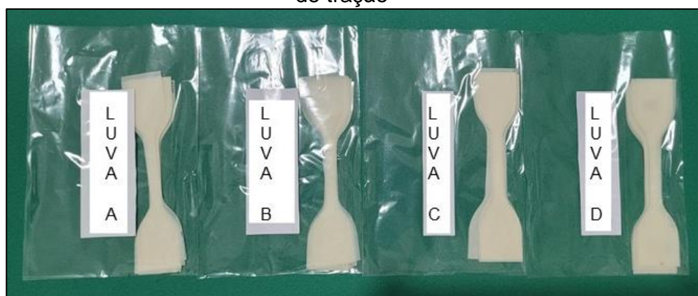
Figura 10 - Corpos de prova de todas as marcas prontos para realização do teste de tração
