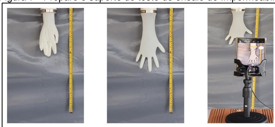
Figura 7 - Preparo e suporte do teste de ensaio de Impermeabilidade
