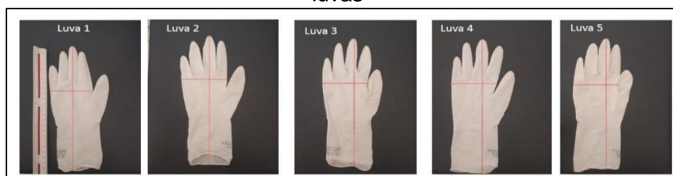
Figura 13 - Pontos de medição para comprimento de largura e comprimento das luvas
