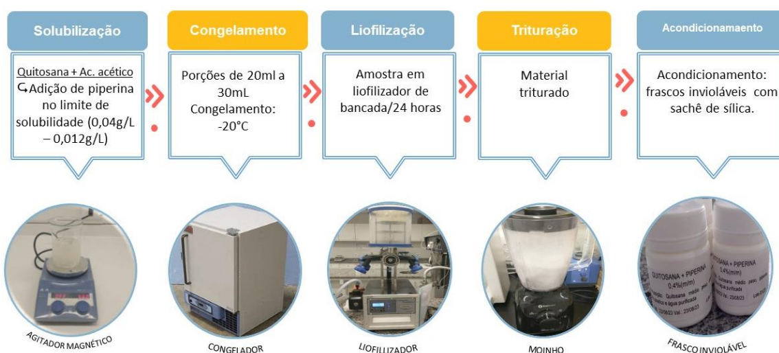
Figura 5 - Fluxograma do processo de obtenção das micropartículas de quitosana/piperina liofilizadas
