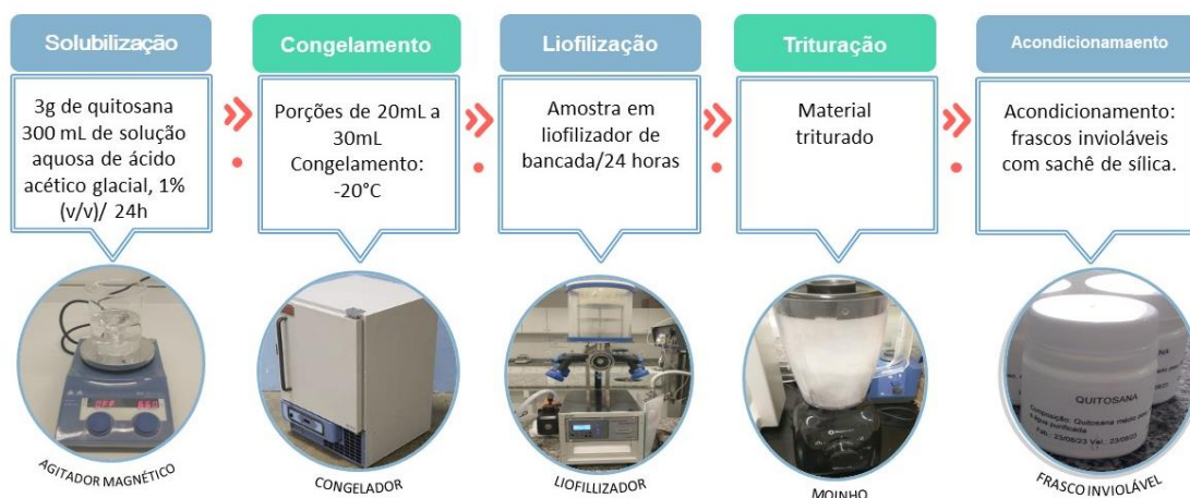
Figura 4 - Fluxograma do processo de obtenção das micropartículas de quitosana liofilizadas
