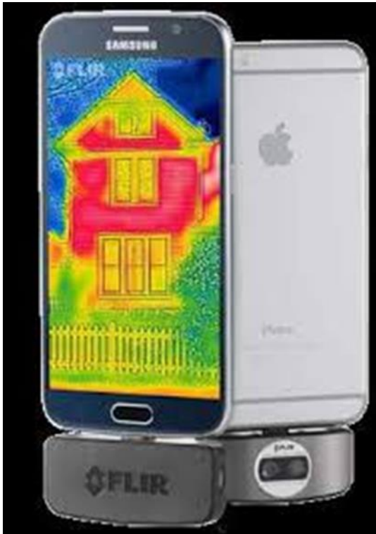
Figura 4. Ilustração de aplicativo para termografia fotográfica infravermelha acoplado em smartphone .
