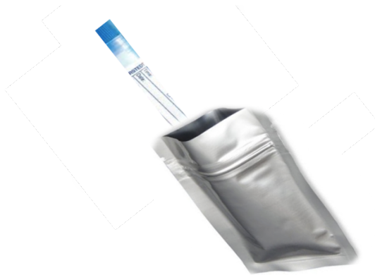
Figura 6 - Ilustração da embalagem que deverá ser usada como proteção da 1ª amostra coletada.
